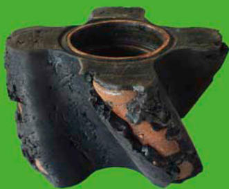
Alter beschädigter Kolben
